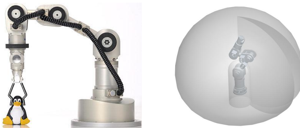
รูปที่ 3 (ซ้าย) แขนหุ่นยนต์ Katana 6M 180, (ขวา) ขอบเขตที่สามารถเคลื่อนที่เข้าไปถึงได้ของแขน Katana
